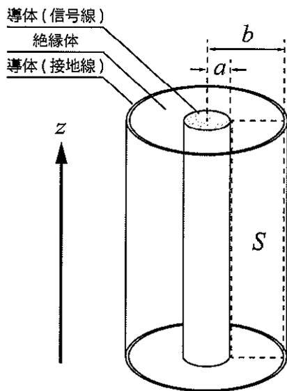
図1 同軸ケーブル (単位長さ). 半径  $a$  の円筒型の導体 (信号線)、半径  $b$  の中空円筒型の導体 (接地線)、その間に挟まれた絶縁体で構成される. 全長は十分長い.
